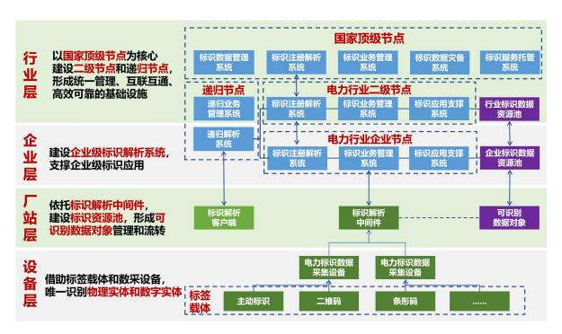
图 5-2 工业互联网标识与电力融合应用架构图
