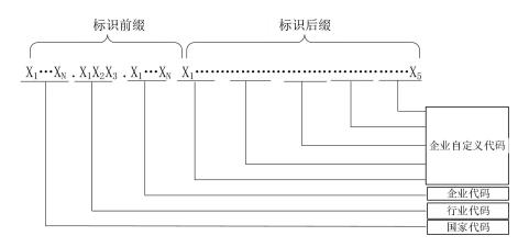
图 5-3 电力行业工业互联网标识编码图
