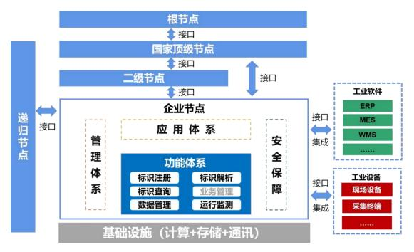
图 5-4 企业层工业互联网标识总体架构图
