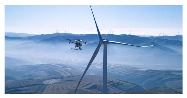
图 3-8 风电无人机巡检工作
