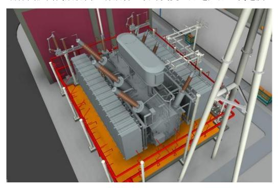
图 3-2 主变压器三维模型
