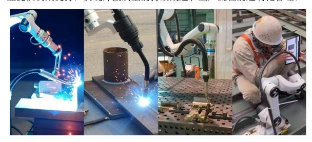
图 3-5 自动化焊接机器人作业
