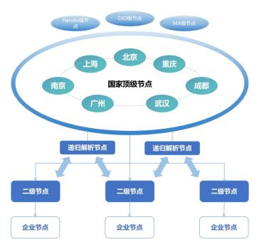
图 5-1 工业互联网标识解析体系总体架构
