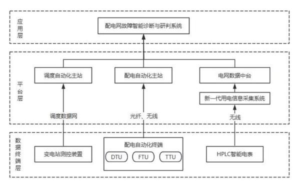
附图 1-6 配电网故障智能诊断与研判系统架构图
