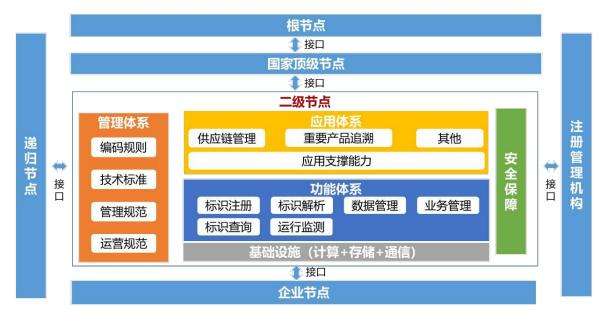
图 5-5 行业层工业互联网标识总体架构图
