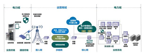
图 4-5 电力 5G 网络建设部署架构图
