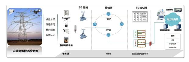
图 4-4 厂(场)站层 5G 和边缘计算应用架构图
