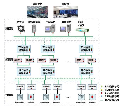
图 4-2 厂(场) 站层时间敏感网络应用架构图
