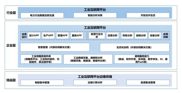
图 6-1 工业互联网平台与电力融合应用架构图
